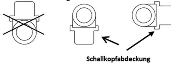
Abb. 6: Empfohlene Einbaulage bei Kältezählung
