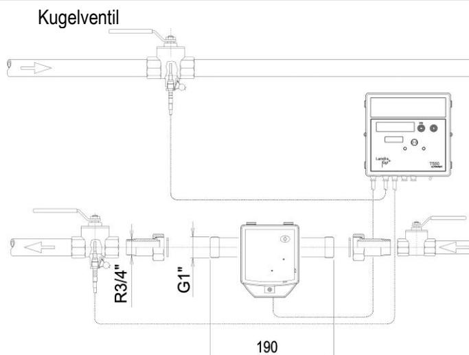
Abb. 1: Einbindung mit Kugelhahn (empfohlen bis einschließlich DN25)
