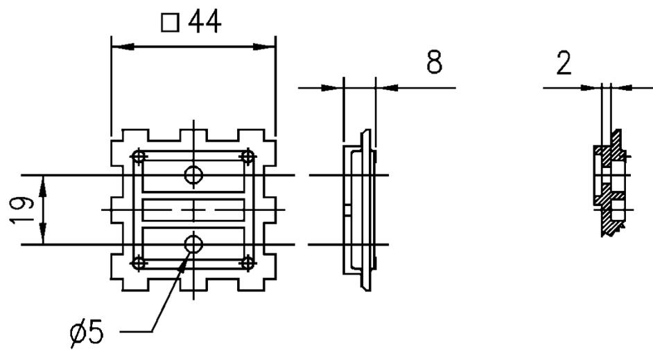
Abb. 6: Draufsicht und Querschnitt von der Adapterplatte
