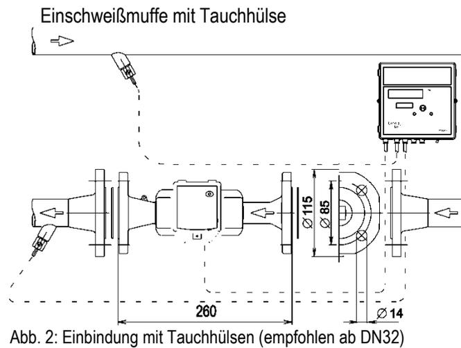
Abb. 2: Einbindung mit Tauchhülsen (empfohlen ab DN32)
